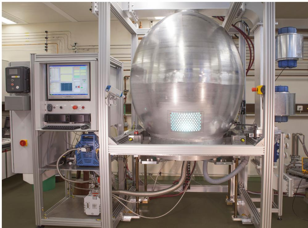
Die besondere Ellipsoid-Form des am Fraunhofer IAF entwickelten Plasma-Reaktors ermöglicht das großflächige Abscheiden von Diamant. © Fraunhofer IAF / Iselin | Bild in Farbe und Druckqualität: [www.fraunhofer.de/presse](http://www.fraunhofer.de/presse).
